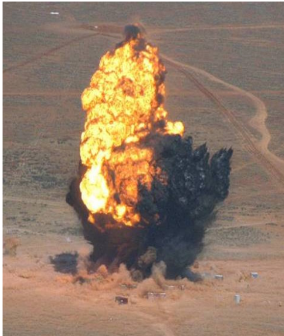
Bilde fra sprengningsforsøk i Woomera, Australia. Norge deltok i tester da 5000 kg sprengstoff ble detonert nær et typisk, sivilt norsk bolighus.
